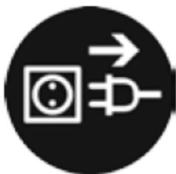
**В случае поломки, выключить двигатель и отключить его от электросети. Ремонт электрических частей может быть выполнен только уполномоченным специалистом по обслуживанию.**
