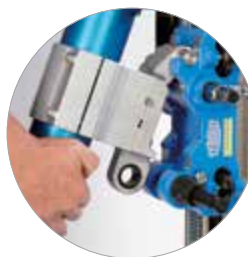
Экономия времени на установку моторного блока, благодаря системе ModulDrill
