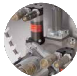
Надёжная режущая голова со стандартными гидравлическими моторами
